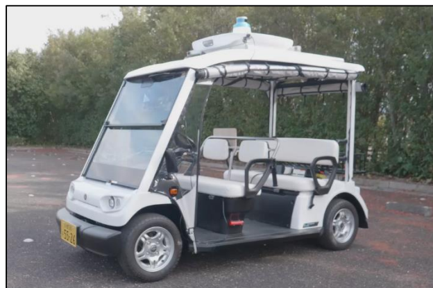
自動運転車両には自動運転開発向け車両を利用。自動運転 OS は、自動車メーカーの自動運転車両でも利用されている Autoware
